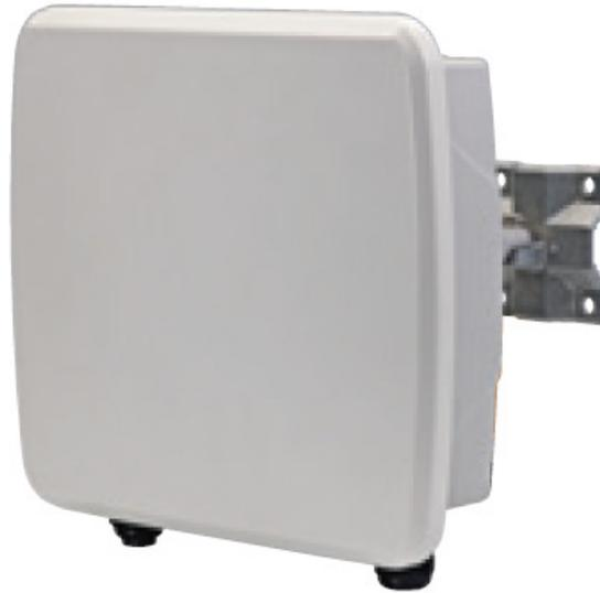
In diesem IP-66 Außen-Antennengehäuse kann ein 5,8GHz Funkempfänger oder ein Funksender eingebaut werden (siehe Bild). Durch die integrierte 16dBi Richtantenne können Richtfunkstrecken über 1km bei Sichtverbindung zwischen Sender- und Empfänger- Antenne aufgebaut werden.
