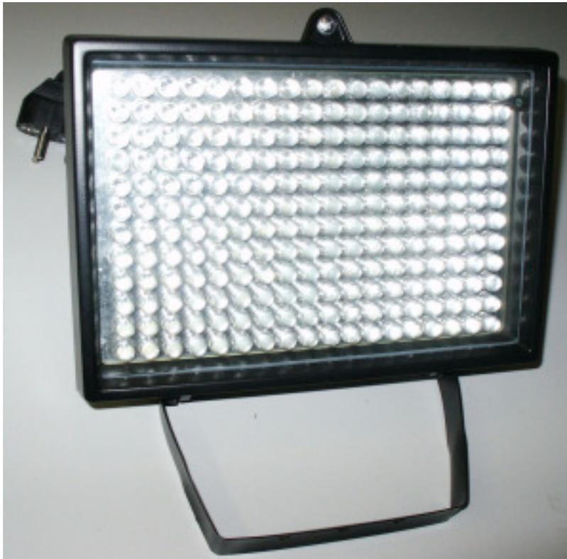
Weitwinkel Infrarotscheinwerfer für Außen und Innen geeignet mit hoher Reichweite und leicht sichtbarem IR-Licht im stabilen abgedichteten Aluminiumgehäuse (IP65) mit stabilem Halter und abgedichteter Reinforce Scheibe. Der integrierte sensorgesteuerte (80mm) Lüfter erhöht durch Kühlung die Lebensdauer der LEDs. Die verspiegelte LED-Platine erhöht die Abstrahlleistung. Integriertes geregeltes Schaltnetzteil, für IR-empfindliche Kameras geeignet.
