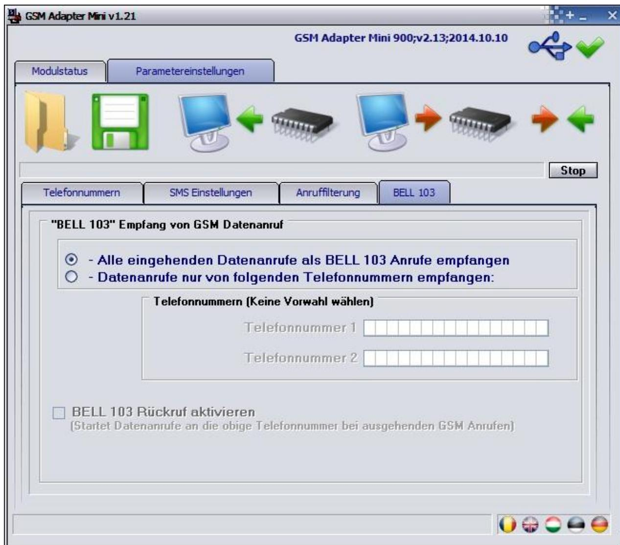
Die BELL103 / V.21 Funktion ermöglicht die Fernprogrammierung der an den GSM Adapter angeschlossenen Alarmzentrale, mit Benutzung des GSM Modems auf der Anruferseite. Der GSM ADAPTER *Mini* benutzt den 13kbit/s breiten GSM Sprechkanal zum Sprechanruf/Tonruf und zur Signalsendung an die Fernüberwachung. Die originale PCM Tonquelle ist dagegen 64kbit/s breit, die wegen der Ausnützung der Kapazität des Funkkanals auf den oben erwähnten Wert verdichtet wurde.
