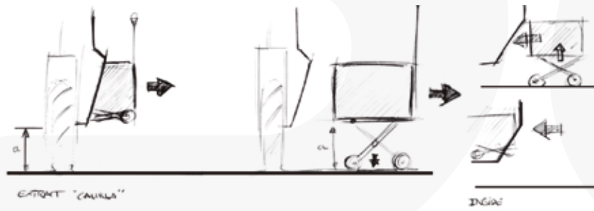
Die ersten Entwürfe des Extraktionssystems des Power Battery Pack im Jahr 2012
