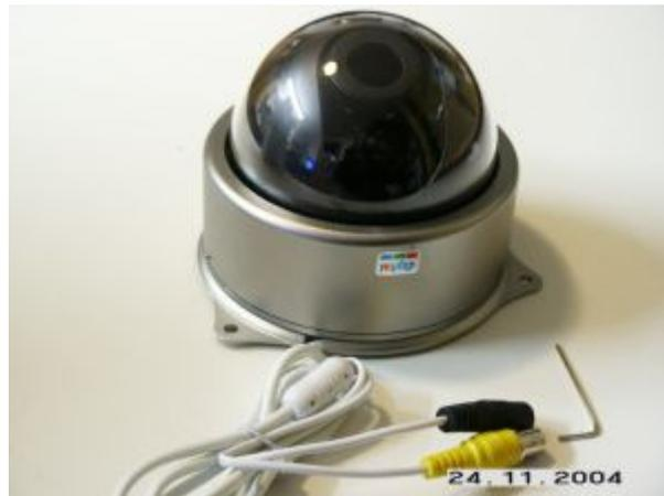
Wetterfeste Vandal Farb- Dome Kamera mit blendengeregeltem Varioobjektiv 3,5-8mm, Digital Signal Processing, sehr stabiles Gehäuse mit Carbonsglas- Kuppel, sehr einfache Installation, hochwertiger Sony CCD Sensor. Die stabile Kamera ist für Innen und Außen geeignet.
