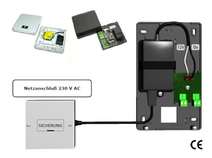
Das Netzkabel ist an einem Ende für den Anschluß an 230 V AC vorgesehen.
