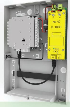
Power-over-Ethernet (PoE) ist eine Technologie, durch die Strom und Daten durch Ethernetkabel geleitet werden, von denen die verbreitetste Kabelart Cat5 ist. Ethernet ist die Sammlung strukturierter Datenkabel, die bereits bestehen, um eine Local Area Network (LAN)-basierte Ausstattung zu verbinden, beispielsweise PCs.
