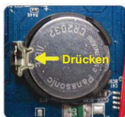
Schritt 5: Nehmen Sie eine neue Batterie mit „CR2032“ nach oben zeigend und installieren Sie sie auf der Hauptplatine.
