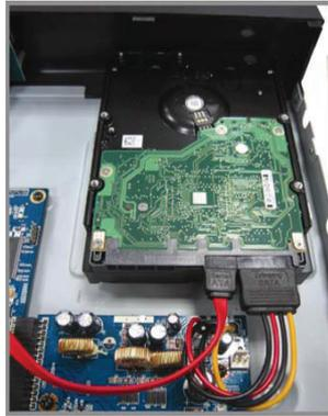
Schritt 4: Richten Sie Schraubenöffnungen an jeder Halterung mit der Schraubenöffnungen der HDD Seiten wie unten gezeigt aus und befestigen Sie die HDD mit den beiliegenden HDD Schrauben an der Halterung.
