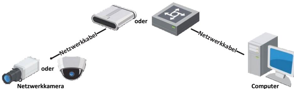
Abbildung 2–2 Verbindung über einen Switch oder Router
