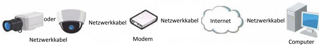
Abbildung 2–12 Auf die Kamera mit dynamischer IP zugreifen
