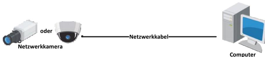
Abbildung 2–1 Direkte Verbindung
