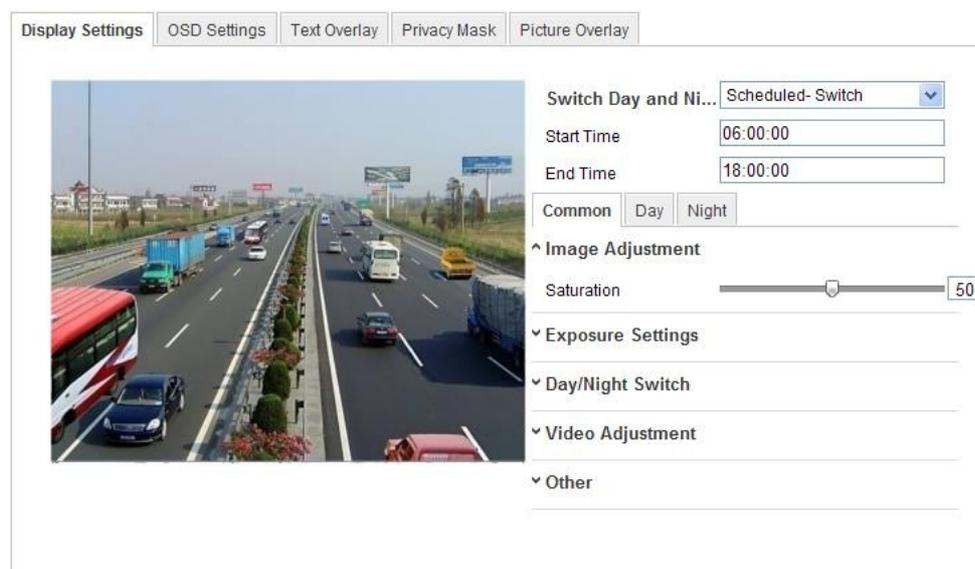
Figure 6-37 Konfigurationsdialog für die geplante Tag/Nacht-Umschaltung
