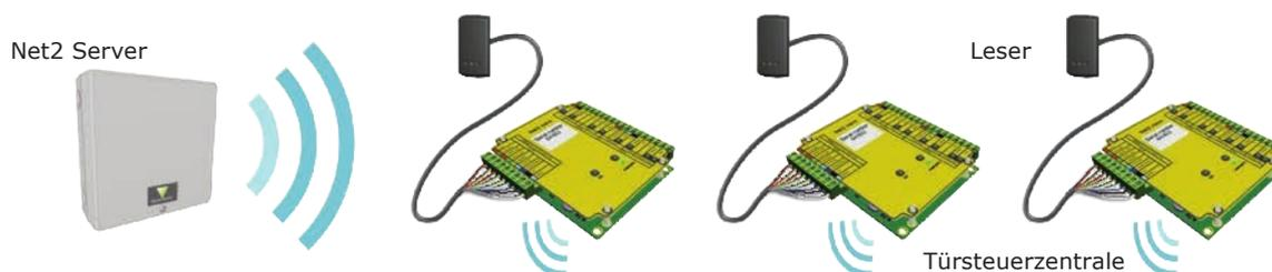
Standardmäßig sind alle LEDs eingeschaltet. Gewährter Zutritt wird angezeigt indem die grüne LED alleine blinkt; wenn er verwehrt wurde blinkt die rote LED.
