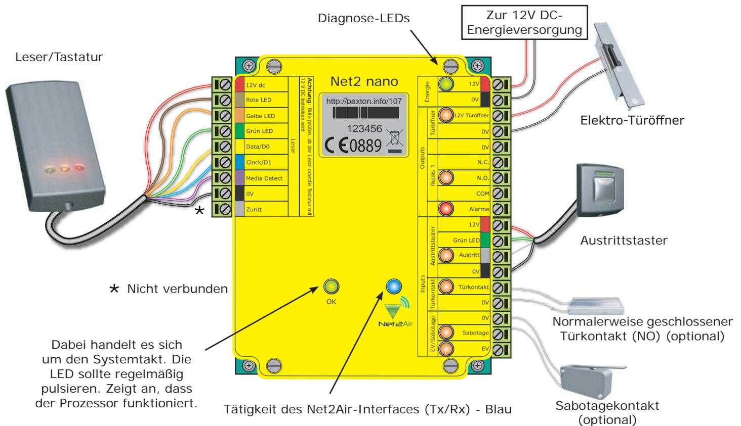
**HINWEIS:** Eine neue Türsteuerzentrale benötigt ca. 30 Sekunden sich selbst zu konfigurieren, nachdem ihr erstmalig Energie zugeführt wurde. Während dieser Zeit wird die Diagnose-LED 'uP LED' der Türsteuerzentrale nicht blinken.
